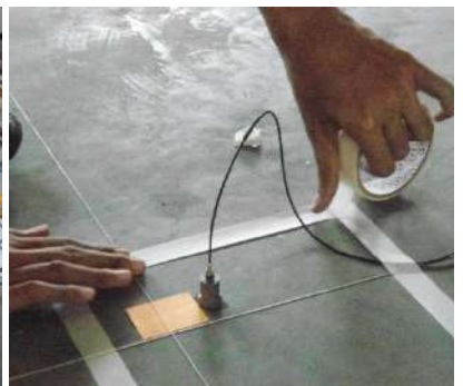
Pengujian Getaran Lantai Gedung PT Genero Pharmaceutical
