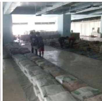
Loading Test Gedung Balok Existing Gedung Imigrasi Kuningan , Jakarta Selatan
