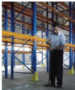
Pengujian Getaran Lantai Gedung PT Genero Pharmaceutical
